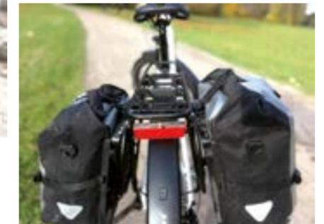
Systemträger, tiefe Packebene, stabiler Träger und Hinterbau, zum Reifen passende, breite Bleche taugen auch zu härteren Touren
