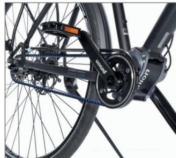
Die Pinion-18-Gang-Getriebschaltung mit Gates-Riemen.
